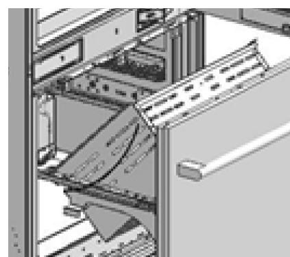
Потяните дверцу вперед, чтобы снять её с крепежей в задней части направляющих.
