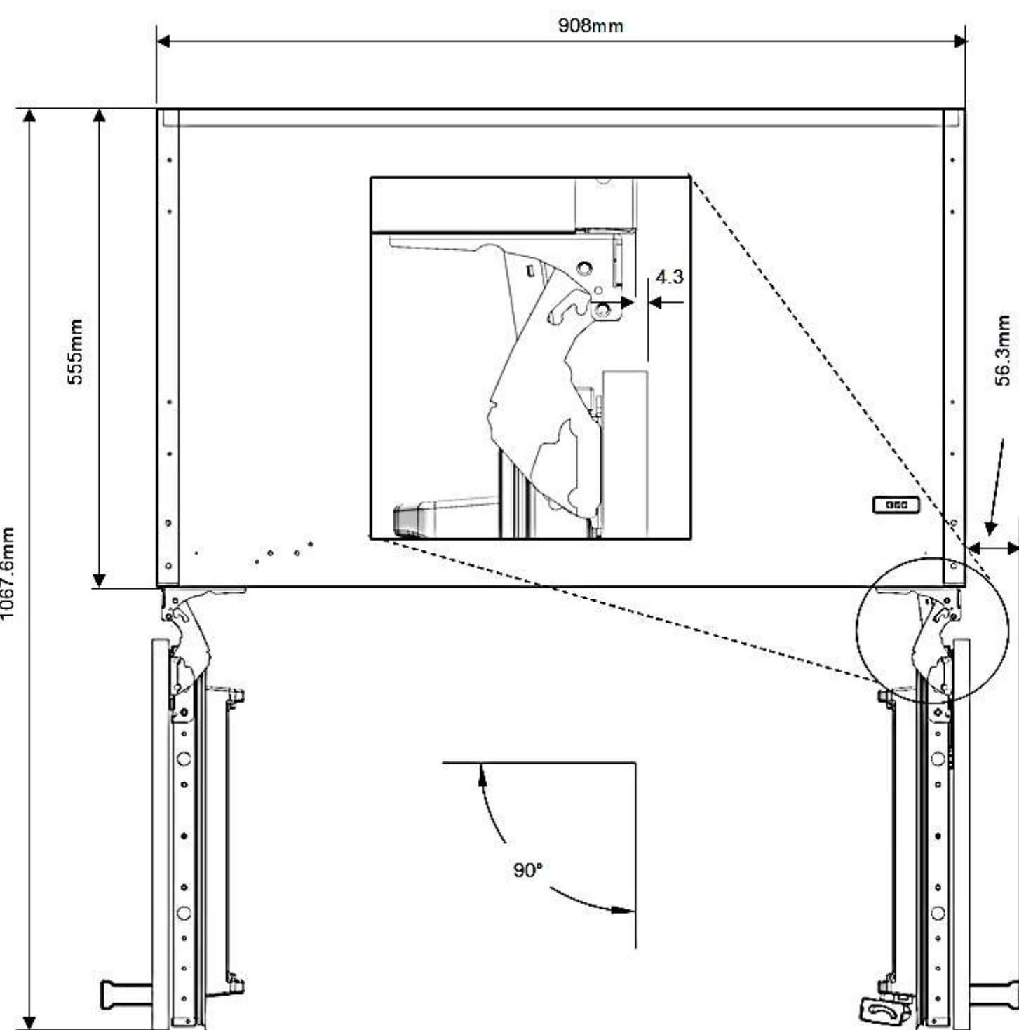
**УСТАНОВКА ПРИБОРА****РАЗМЕРЫ ДЛЯ МОНТАЖА**
