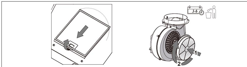
В режиме рециркуляции воздух возвращается назад на кухню через отверстие в вытяжке. Этот метод рекомендуется использовать, если вы редко пользуетесь варочной панелью. При рециркуляции воздуха необходимо использовать угольный фильтр для удаления запахов.
