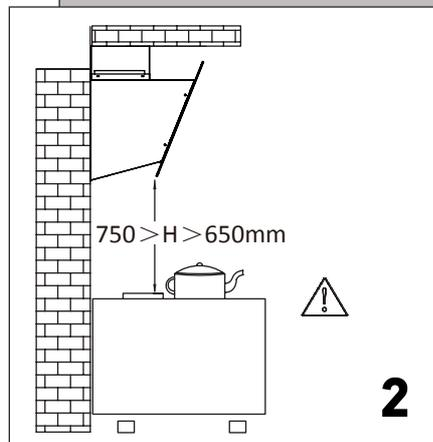
Минимальное расстояние от нижней точки вытяжки до варочной панели - 650мм; максимальное - 750 мм.
