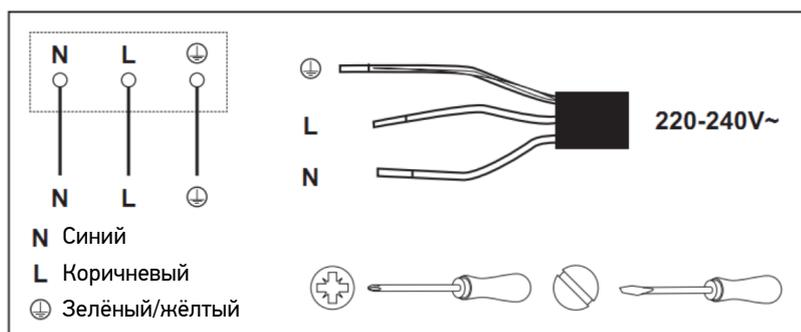
**Для этого прибора требуется миниатюрный автоматический выключатель на 32 ампера.**
