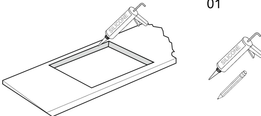
Сделайте выпил в столешнице, используя подходящее оборудование (рис. 1). Обработайте края выпила специальным силикатным герметиком. Дождитесь его высыхания.
