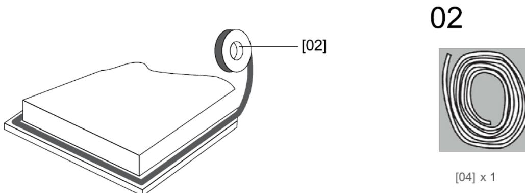
Уплотнитель идет в комплекте с варочной панелью. Уложите уплотнитель по всему периметру отверстия для монтажа.
