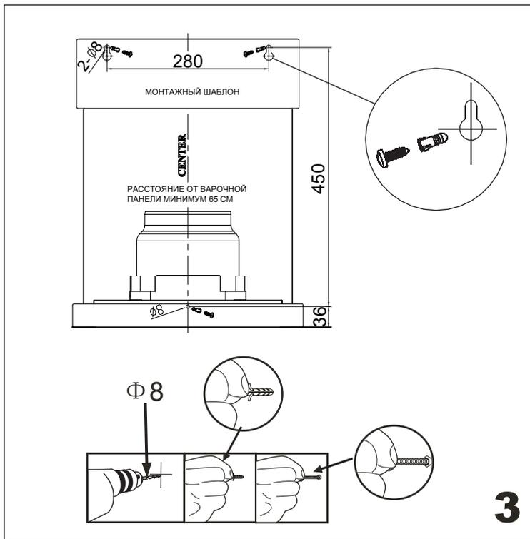
В соответствии с рис.3 сделайте разметку для вытяжки на стене. Затем используйте трафарет, просверлите три отверстия  $\text{Ø}8$  в стене. Установите фиксирующие наборы расширяющих дюбелей и шурупов в трех отверстиях.
