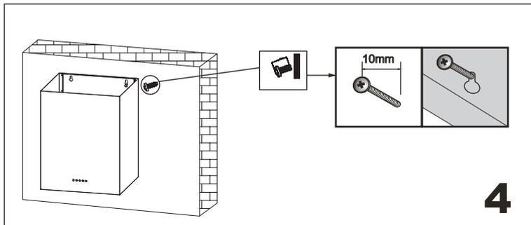
Отрегулируйте положение корпуса вытяжки с помощью трех винтов направленных в отверстия, как показано на 4 картинке.
