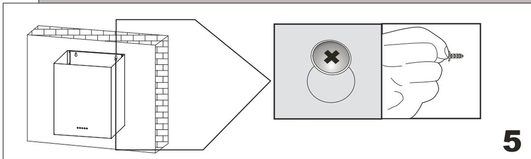
Закрутите четыре винта. Сначала закрутите два верхних винта, затем закрутите остальные.
