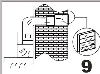
Вентиляционную трубу можно так же вывести горизонтально через наружную стену.
