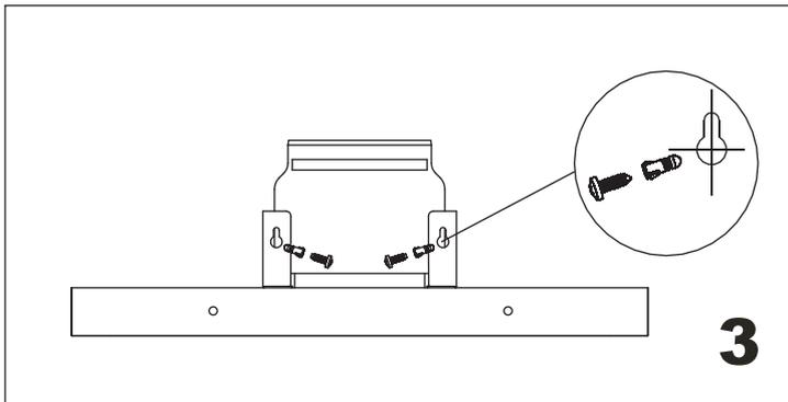
В соответствии с рис.3 сделайте разметку для вытяжки на стене. Затем используйте трафарет, просверлите четыре отверстия  $\Phi 8$  в стене. Установите фиксирующие наборы расширяющих дюбелей и шурупов в четырех отверстиях.
