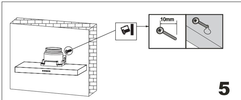
Отрегулируйте положение корпуса вытяжки с помощью двух винтов направленных в отверстия.
