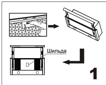
Проверьте соответствие используемого напряжения и частоты питающей сети с информацией на шильде, расположенной на внутренней части корпуса.
