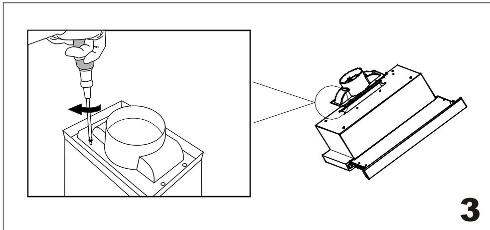
Перед установкой вытяжки сначала установите обратный клапан.
