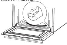
Перекидывание предохранительных защелок петли
