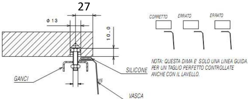
2) Determinare la posizione delle staffe di fissaggio.
