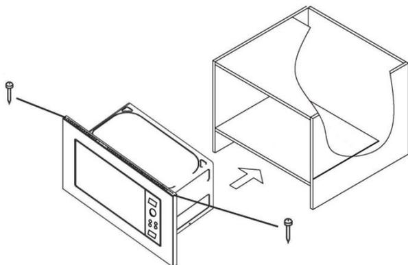
Откройте дверцу микроволновой печи, вставьте винт и вкрутите его в полку шкафа. Закройте шляпку винта колпачком. Установка завершена.
