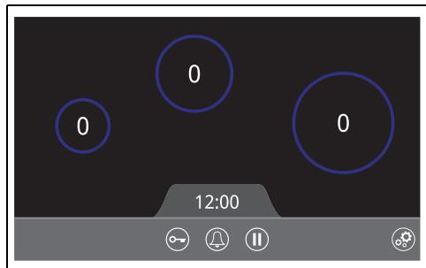
Посуда автоматически распознается при включении прибора.
