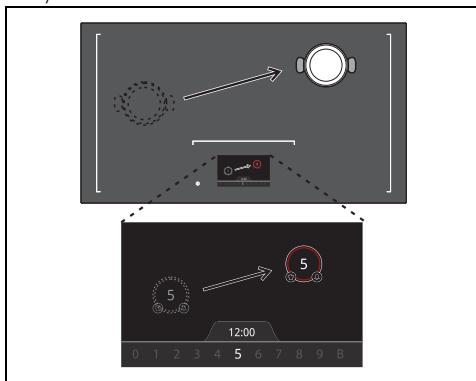
Когда емкость поднимается, прибор приостанавливает все выполняющиеся операции (как готовку, так и приготовление по таймеру) и на дисплее она отображается
