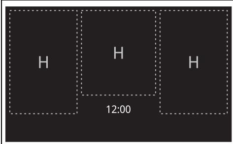
В обоих случаях, как только температура варочной зоны опускается ниже порога безопасности, пропадает соответствующий индикатор остаточного тепла.
