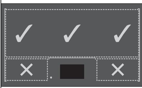
Если используется слишком большая емкость или емкость не круглой формы, может случиться, что перед включением она будет определена как две разные емкости. Достаточно слегка подвигать емкость на поверхности или поднять и опустить ее для правильного обнаружения.
