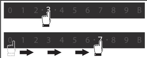
Можно выбрать промежуточные уровни мощности между целыми числами, определяемые устанавливаемой между ними точкой. Например, уровень мощности 4,5:
