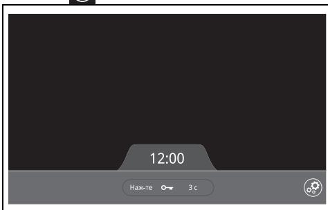
Для отключения блокировки панели управления нажмайте на кнопку с ключом в течение 3 секунд. Анимация указывает на процесс выключения:
