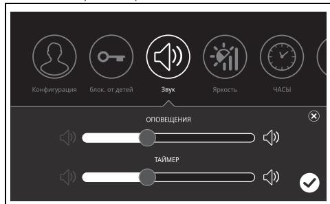
Полосой «Оповещения» регулируется громкость всех звуковых сигналов, за исключением громкости звука истекшего времени таймера. Полоса «Таймер» позволяет отрегулировать только громкость звукового сигнала таймера. Установка в крайнее левое положение обнуляет громкость, в крайнее правое делает ее максимальной.
